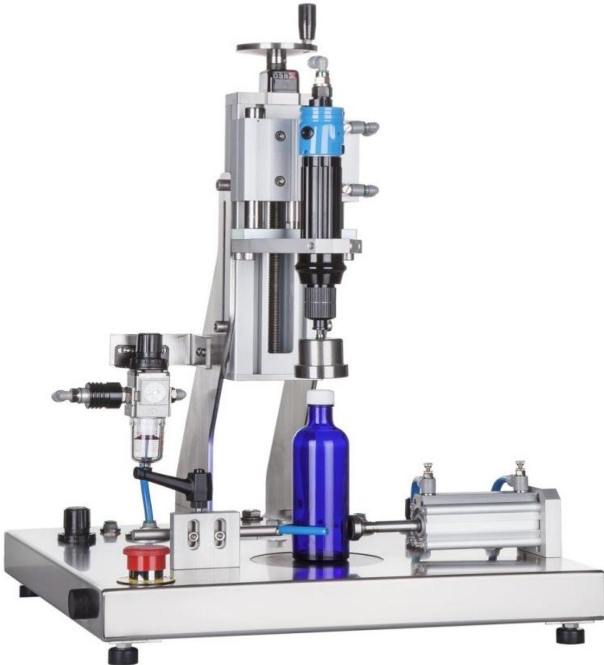
La visseuse **TP003** est un module de vissage semi-automatique indépendant permettant de visser les bouchons de tous types de produits. À l'aide d'une visseuse intégrée, ce module vissera les bouchons de vos contenants. Facile d'utilisation, il dispose d'une commande bi manuelle et du réglage du couple de vissage sur la tête de la visseuse.
