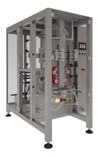
Die INVpack-Modellreihe VA ist eine einbahnige und vertikal arbeitende Schlauchbeutel-Verpackungsmaschinen für unterschiedliche Schlauchbeutelgrössen. Der Schlauchbeutel ist die klassische Form des Beutels von der flachen Folienbahn. Die Folie wird über die Formatschulter geführt, direkt um das Formatrohr geformt, längs versiegelt sowie an der Bodennaht verschlossen. Nun wird das Produkt eingefüllt, der Beutel im Anschluss an der Kopfnaht verschlossen und vom Folienschlauch abgetrennt.
