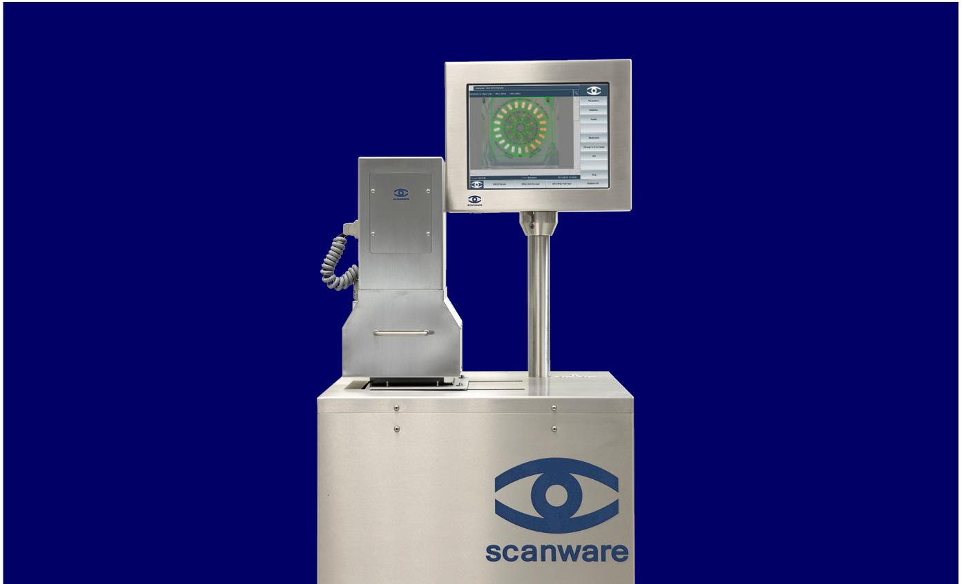
Das Inspektionssystem SPECTRA HR wird zur Qualitätskontrolle im pharmazeutischen Bereich eingesetzt. Durch Einsatz von mehreren 3CMOS-Kameras bietet es eine herausragende Farbtrennleistung, wodurch auch Produkte mit schwierigen Farb- und Kontrastgegebenheiten inspiziert werden können. Auch die Prüfung von Produkten mit minimalen Unterschieden von Farbe und Form im selben Blister setzt das System in Hochgeschwindigkeit um.
